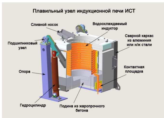
Рис. 2 Индукционная печь в разрезе
